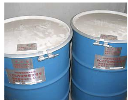
PCB 含有廃棄物の適正保管
