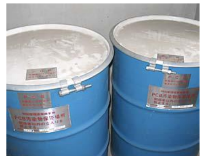
PCB 含有廃棄物の適正保管
