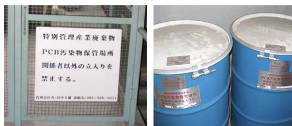
PCB 含有廃棄物の適正保管
